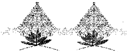
a) Esquema de aspersión en forma de cortina con una boquilla por surco
